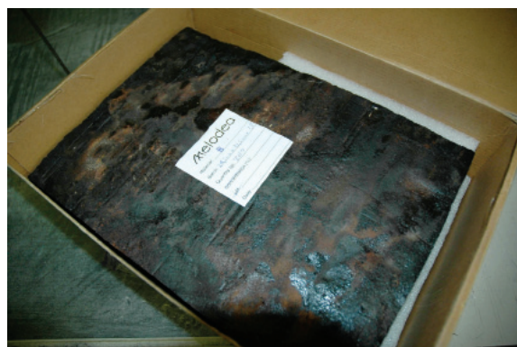
Slika 3: Vzorci lahkih penastih plošč BRIMEE v različnih fazah razvoja
